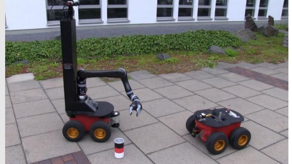
Der Roboter AMPARO und ein Scout Roboter während einer koordinierten Mission, wobei Module erkannt und transportiert werden.
