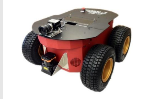
Mehrere Roboter vom Typ Pioneer P3-AT sind als Explorationsroboter vorgesehen und werden zur Lokalisierung der Module eingesetzt, welche von Amparo eingesammelt werden.
