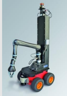
Der mobile Roboter Amparo wird für das Aufsammeln der lunaren Module verwendet.
