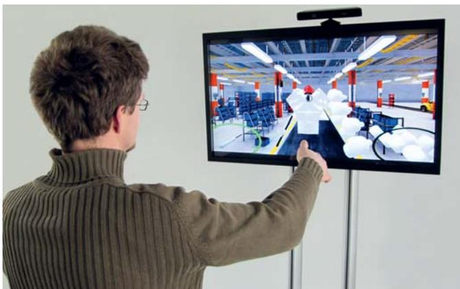
Benutzer des VISTRA-Trainings-simulators während der Montage eines Motorblocks
