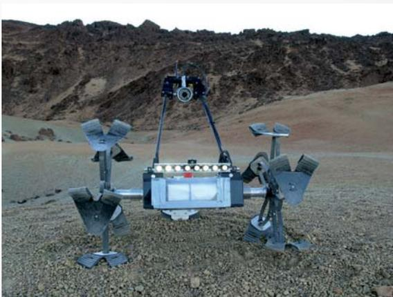
einstellen, vom hellen Sonnenlicht bis zu völliger Dunkelheit im Inneren des Kraters. Die Obergrenze für das Gewicht lag bei 100 kg, der Energieverbrauch durfte 2 kW nicht übersteigen, und die Roboter sollten in einen Transportbehälter mit einem Volumen von 0,5 m<sup>3</sup> passen.
