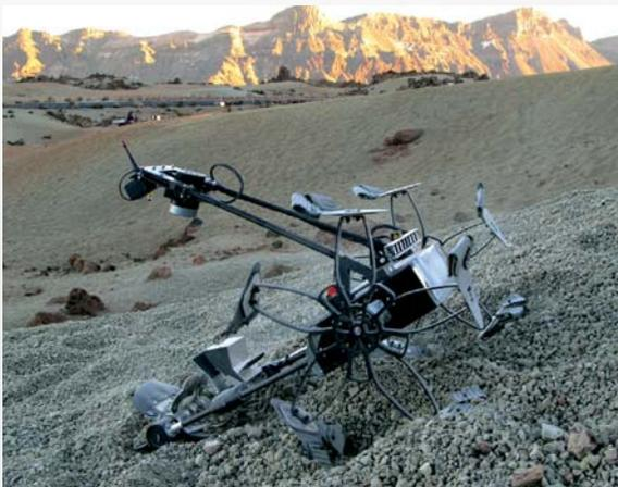
Die Studenten hatten sechs Monate Zeit, um die von ihnen erfolgreich eingereichten Entwürfe umzusetzen. Die Aufgabe bestand darin, einen Roboter zu konstruieren, der in der Lage ist, aus einem bis zu 15 m tiefen Krater mindestens 100 g Bodenproben zu entnehmen und nach oben zu transportieren. Das Gefälle konnte dabei bis zu 40° betragen. Zudem mussten sich die Roboter auf die unterschiedlichsten Lichtverhältnisse
