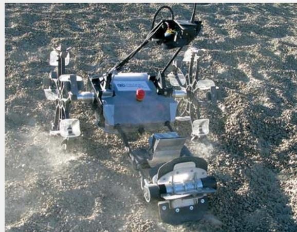
Der Roboter ist 85 cm x 120 cm groß und wiegt acht Kilo. Interessant ist auch das Konzept für die Orientierung von CESAR im Dunkeln: Ein Laser projiziert eine rote Linie etwa einen Meter vor dem Roboter auf den Boden. Diese hilft dem Operator im Kontrollzentrum, die Bodenbeschaffenheit einzuschätzen und insbesondere Mulden rechtzeitig zu erkennen.
