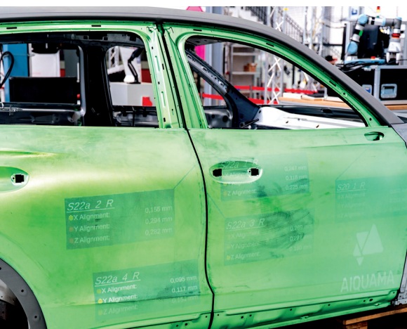
Über eine Projektion erhält der Werker eine KI-basierte Handlungsanweisung für die exakte Justierung der Tür.
