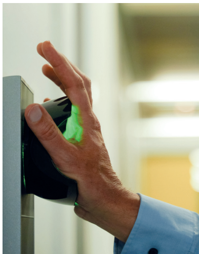
Der Zugang zum SEMLab ist mit einem Handvenen-Scanner biometrisch gesichert.
