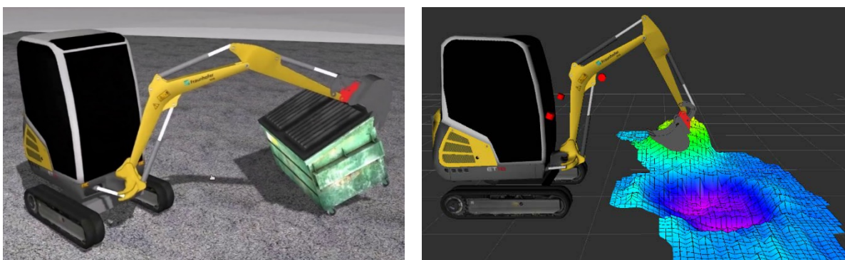
Abbildung 7: Links: Überprüfung des kinematischen Baggermodells in der Simulation Rechts: Bagger mit der aus den Punktwolken gewonnenen Umgebungskarte des Aushubbereichs. Die Einfärbung der Karte codiert die Höhe (magenta=tief, gelb = hoch)
