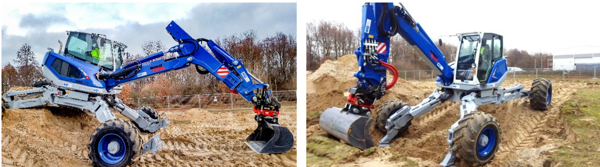
Abbildung 1: Schreitbagger als Basis des Realisierungsprojekts „Dekontamination von Deponien“ im Rahmen von ROBDEKON
