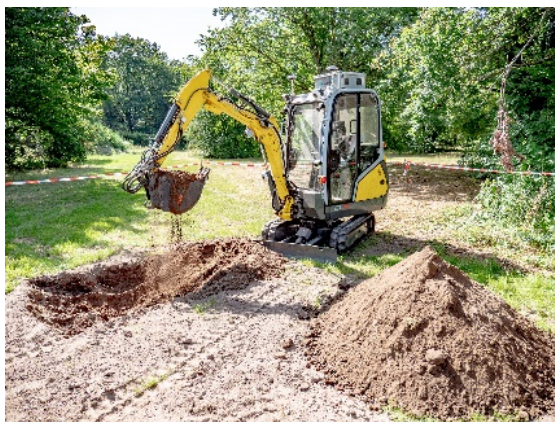
Abbildung 3: Automatisierter Bagger ohne Bediener (BoB) des IOSB bei einem autonomen Aushubvorgang
