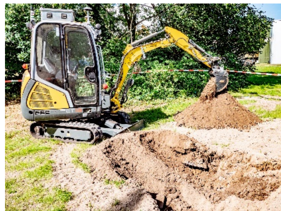
Abbildung 3: Automatisierter Bagger ohne Bediener (BoB) des IOSB bei einem autonomen Aushubvorgang
