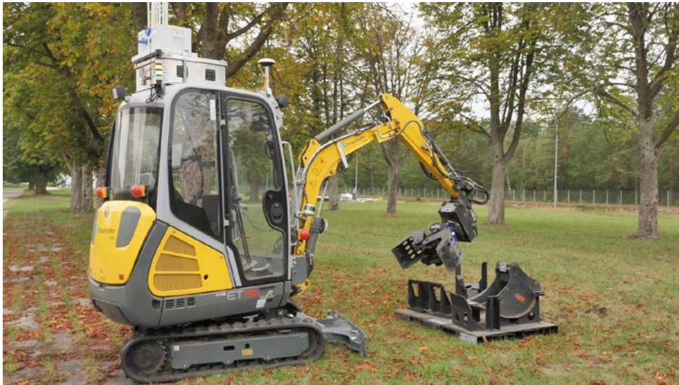
Abbildung 10: Bagger führt autonom einen Werkzeugwechsel Greifer/Löffel durch.
