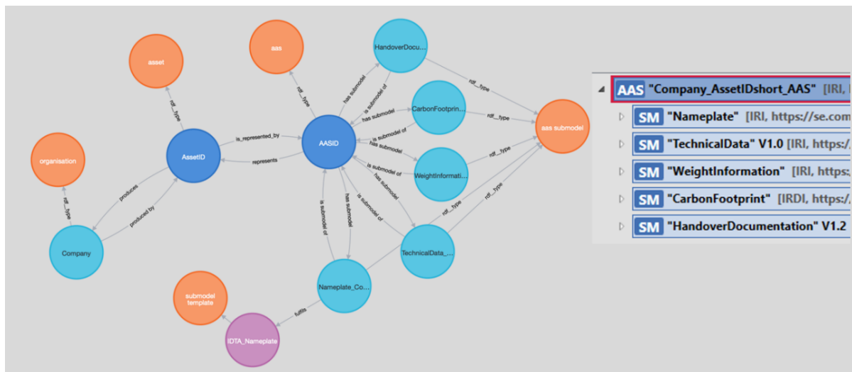
Abbildung 58: Digitaler Zwilling (links) als Graph der Ontologie mit (rechts) seiner AAS und deren Submodellen
