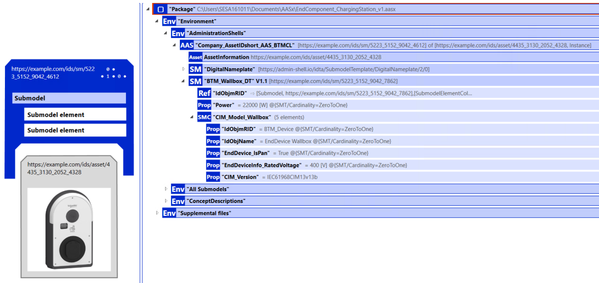
Abbildung 55: AASx-Struktur am Beispiel einer Ladesäule
