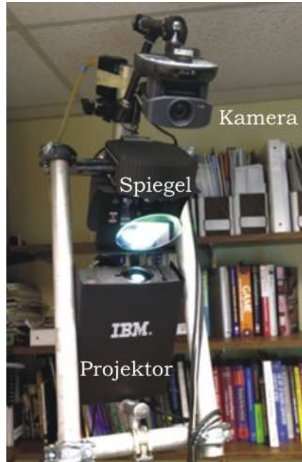
Abbildung 2.2: Everywhere Displays Projektor (Bildquelle: www.research.ibm.com )
