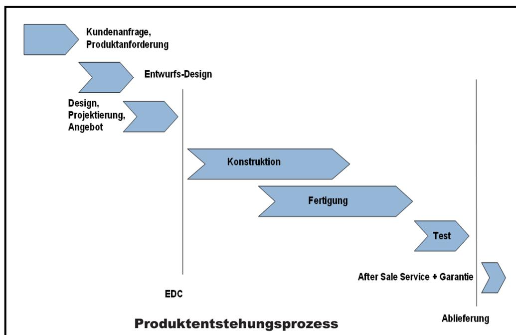
Besondere Rahmenbedingungen für die rechnerbasierte Konstruktion im Schiffsbau sind allerdings durch die geringen Stückzahlen und die Individualität der Produkte gegeben. Diese individuelle Fertigung erzwingt permanente Adaptionen und Modifikationen im Konstruktionsprozess und einen verteilten Entwicklungsprozess in Kooperation von Fertigung und Planung. Ein permanenter Abgleich von geplanten und gefertigten Bauteilen und eine effektive Kommunikation ist hierbei unbedingte Voraussetzung.
