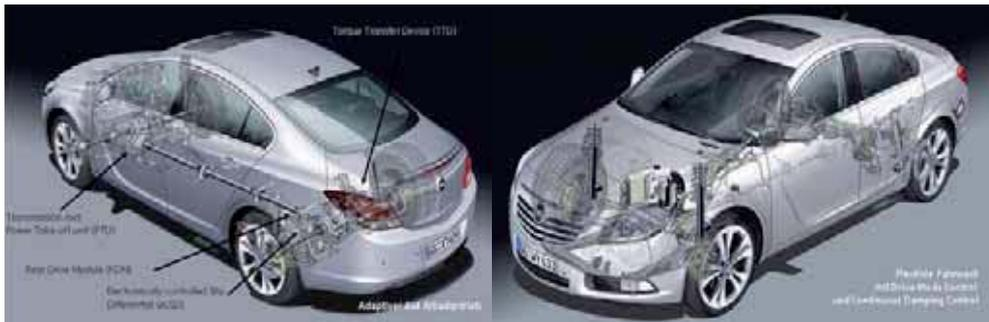
Bild 4: FlexRide Fahrwerk / FlexRide Fahrwerk mit adaptivem 4x4 Allradantrieb
