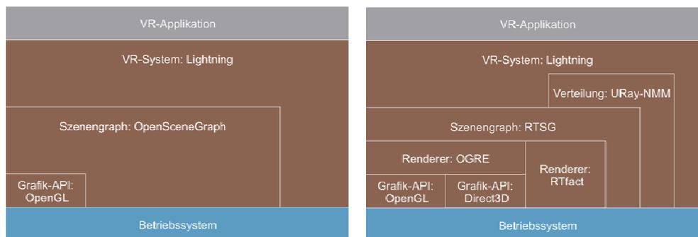
Abbildung 3 Architektur eines klassischen VR-Systems (links) und des integrierten Systems (rechts)
