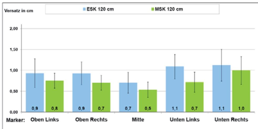
Abbildung 2: Mittlere Überlagerungsfehler sowie Standardabweichungen zwischen realen und virtuellen Markern in einem Testabstand von 120 cm. Die Markerpositionen entsprechen der Markeranordnung aus Abbildung 1, rechts.
