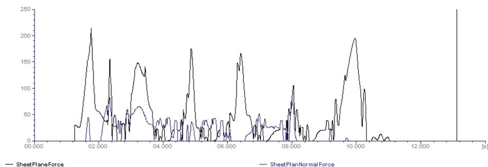
Abbildung 3: Greiferkräfte beim Einlegen eines Teils in eine Maschine (Normalkraft (schwarz) und Transversalkraft (blau) im Greifer)
