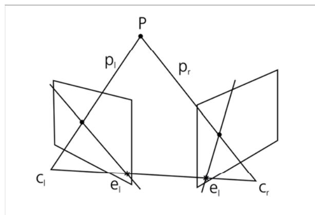
Schema der Stereo-Triangulation
