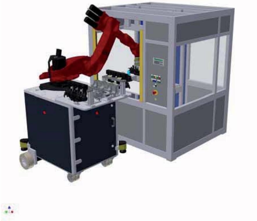
Abbildung 3: Bild des VR-Modells vom mobilen Roboter mit einer Arbeitszelle und Werkstücken
