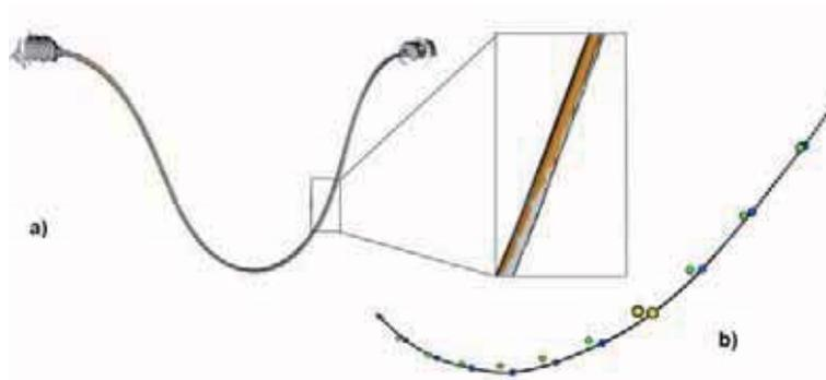
Abbildung 1: Zunächst wird der Formverlauf der digitalisierten Realität und der der Simulation mit den ermittelten Materialparametern überlagert (a). Zur genaueren Analyse wird nun die Mittellinie des Scans mit der Mittellinie der Simulation verglichen (b).
