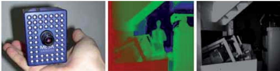
Abbildung 1: Links: SwissRanger 3000. Mitte: Tiefenbild (farbkodierte Darstellung der Distanz). Rechts: Intensitätsbild.
