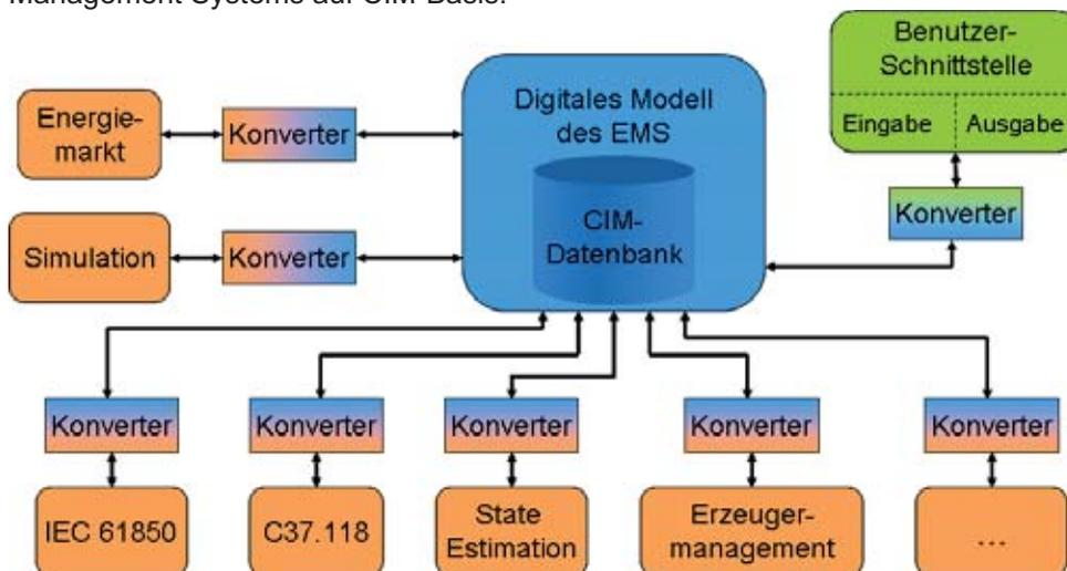
Abbildung 2: Digitales Modell eines EMS unter Verwendung von CIM.
