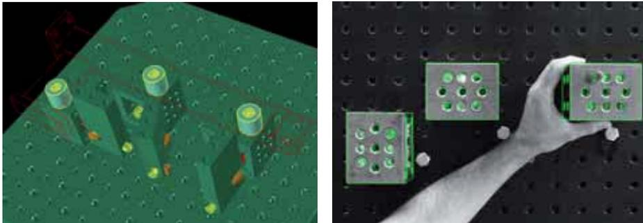
Abbildung 3: Links: Darstellung der extrahierten Teile einer komplexen 3-D-Szene. Die automatisch vorgeschlagenen Objekte für den nächsten Arbeitsschritt sind farblich hervorgehoben. Rechts: Lagekorrekte Überlagerung von CAD-Daten auf einem realen Kamerabild durch Positionserfassung der Kamera, Bildverzerrung und Rendering der Objekte.
