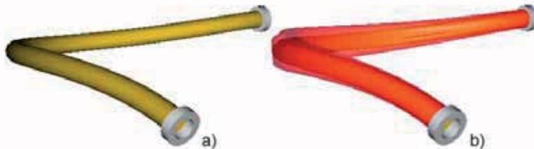
Abbildung 4: Simulation eines Kabelbündels. a) Simulation mit absoluten Werten. b) Simulation und Darstellung eines Hüllvolumens eines Kabelbündels unter Angabe einer Toleranz im Elastizitätsmodul.
