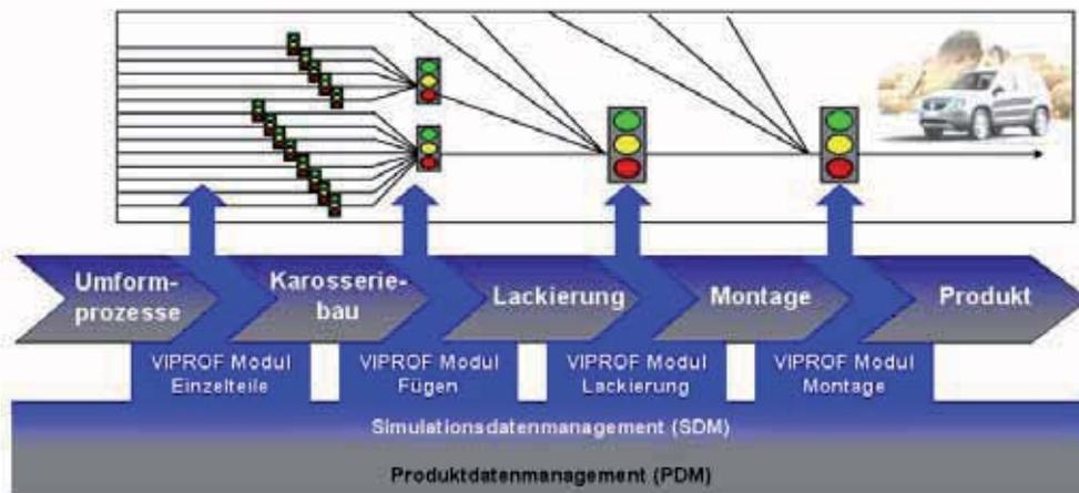
Abbildung 2: Virtuelle Verbindung der Teilwerke vom Einzelteil bis zum Produkt in einer Prozesskettensimulation.
