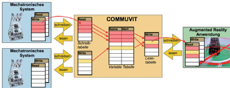
Bild 3: Funktionsprinzip von COMMUVIT
