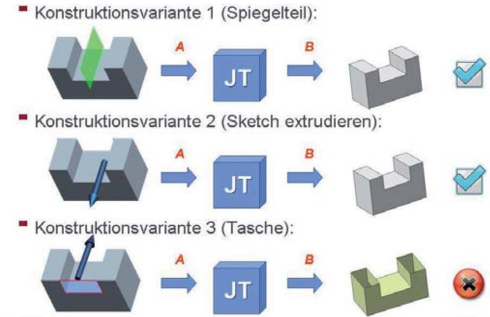
Abbildung 4: CAD-Methodik abhängiges Konvertierungsproblem
