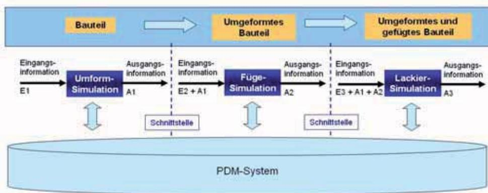
Abbildung 3: Verknüpfung von Simulationsprogrammen über ein PDM-System.
