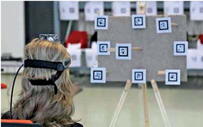
Abbildung 2: Prototyp eines Kalibrierkörpers für die Ein-Schritt-Kalibrierung
