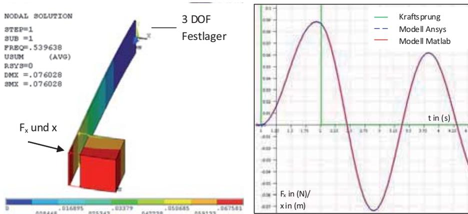
Abbildung 2: Dominante erste Eigenfrequenz der schwach gedämpften Mechanik (links) und Simulation mit Kraftsprung (rechts)
