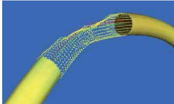
Abbildung 5: Visualisierte Schlauchhülle; an der Schadstelle ersetzt durch Punktwolke, welche sich durch zunehmenden Verschleiß deformiert. Ein abweichender Schlauchverlauf resultiert aus dem örtlichen kumulierten Verschleiß.
