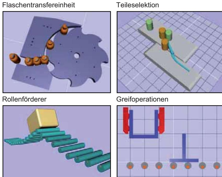
Abbildung 1: Echtzeitfähige Simulation von Handhabungssystemen mit virtuos
