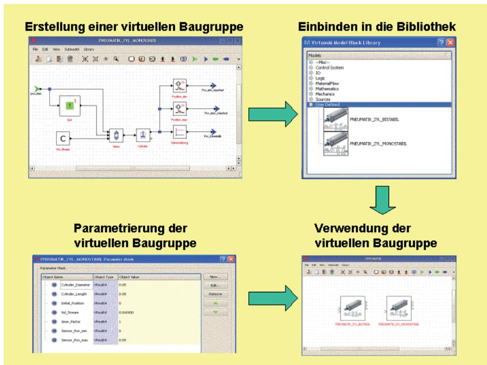
Abbildung 3: Erstellung und Verwendung von virtuellen Baugruppen (Beispiel: Simulationswerkzeug ISG-virtuos zur HILS)
