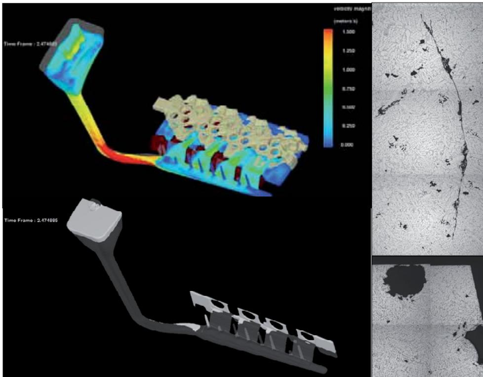
Abbildung 1: Ergebnisse einer Formfüllberechnung: Fließgeschwindigkeit (o.li) und Lufteinschlüsse im Laufsystem (u.li) sowie typische formfüllbedingte Gussfehler: Oxid und Blase (re)
