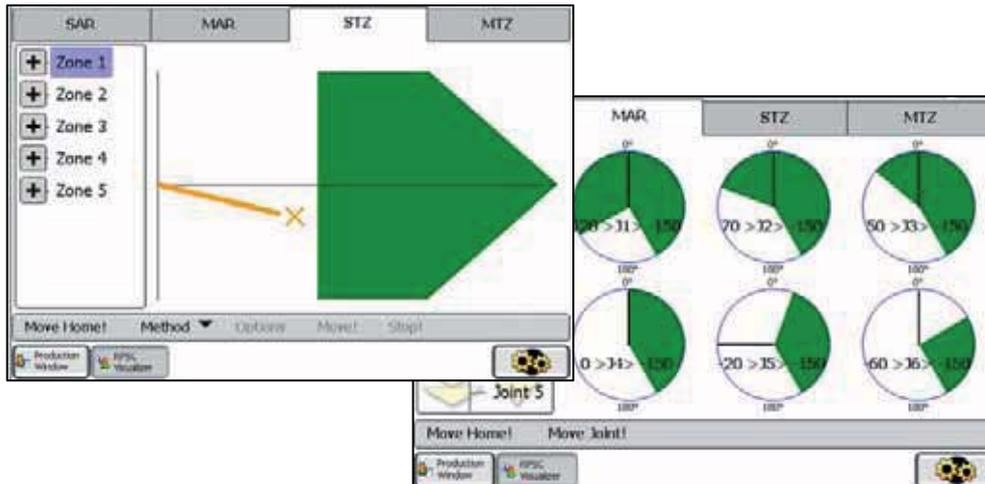
Abbildung 3: Links: Visualisierung einer Sicherheitszone mit Roboterposition auf dem Bedienhandgerät. Rechts: Darstellung von Achsbereichsvorgaben mit den jeweiligen Achspositionen.
