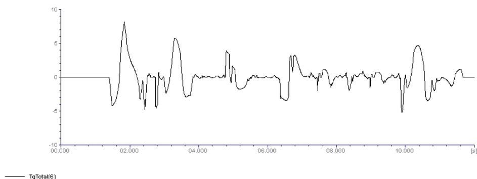
Abbildung 4: Antriebsmoment einer Zusatzachse
