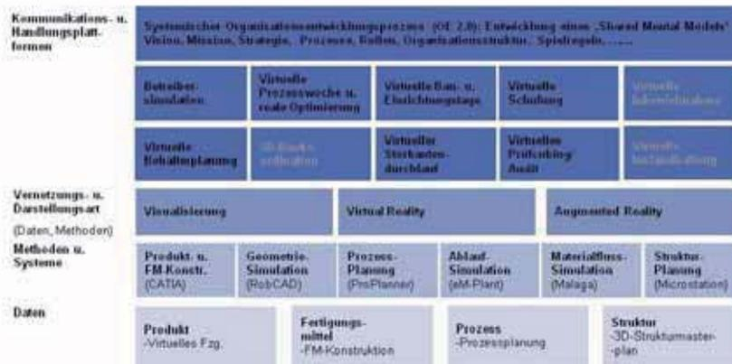
Abbildung 3 :Systemische Organisationsentwicklung zur Integration der ‚digitalen Fabrik‘ in die Fabrik (nach BMW AG, Werk Leipzig, Knau, J., Aghaei, F., 2006-2009, Digitale Fabrik im Werk Leipzig)
