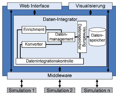
Abbildung 3: Systemarchitektur der Simulationsplattform
