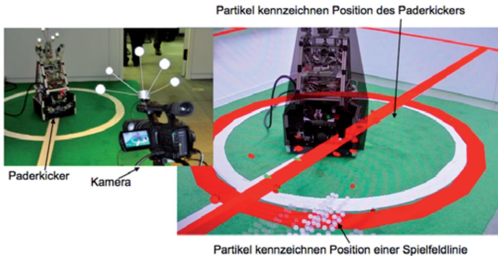
Bild 6: AR zur visuellen Analyse von autonomen Fußballrobotern
