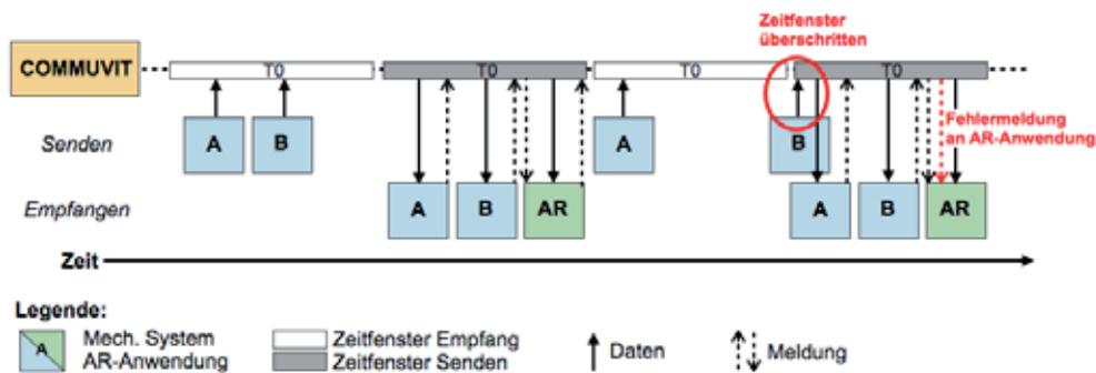
Bild 4: Zeitfenster und Zeitstempel ermöglichen eine synchrone Datenübertragung und sind Voraussetzung für konsistente Daten.
