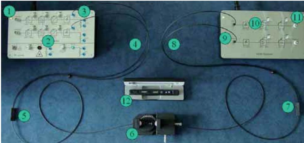
Abbildung 1: OPTOTEACH-Lehrsystem: (1) BNC-Eingänge, (2) Einstellregler für Offset & Verstärkung, (3) Optische Ausgänge, (4) Polymerfaser (5) Koppler, (6)  $\mu\text{m}$ -Tisch, (7) Splitter, (8) Polymerfaser, (9) Optische Eingänge, (10) Einstellregler für Spannung & Verstärkung, (11) BNC-Ausgänge, (12) Optisches Powermeter.
