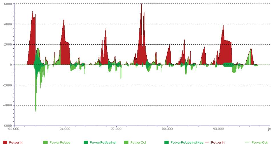
Abbildung 5: Leistungsaufnahme (rot) bzw. -abgabe (grün) der Antriebe auf einer Roboterbahn
