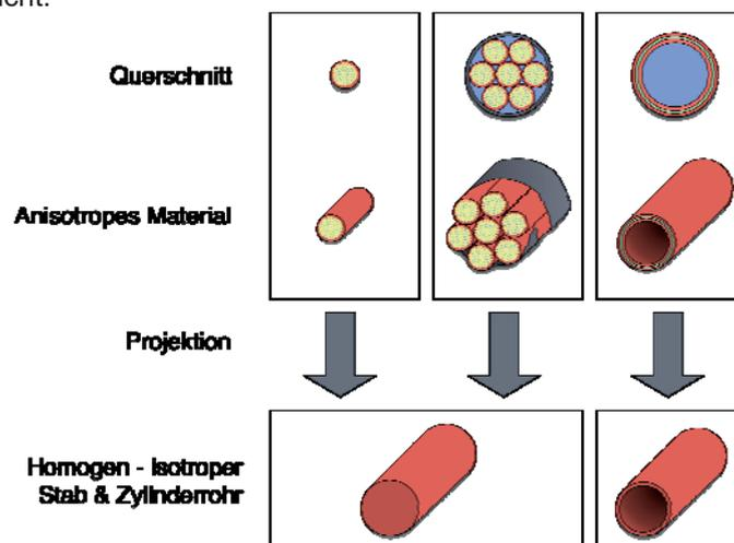
Abbildung 2: Projektion der Materialparameter auf Stab oder Zylinderrohre: Mit der Übergabe der Materialparameter werden diese auf Stab- oder Zylinderrohre projiziert. Je mehr Lufteinschlüsse ein Material aufweist, desto höher ist die Abweichung des eigentlichen Materials zu den physikalischen Werten, die aus standardisierten Messverfahren stammen.
