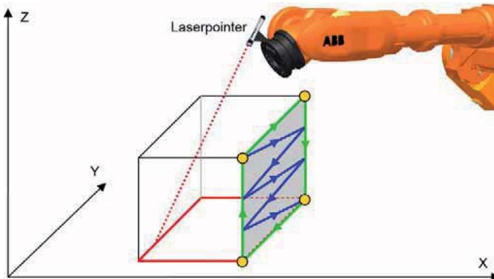
Abbildung 4: Visualisierung für Sicherheitszonen: Eckpunkte (gelb), Kanten (grün), Flächen (blau) oder eine Projektion der Zone auf den Fußboden (rot) können angefahren werden
