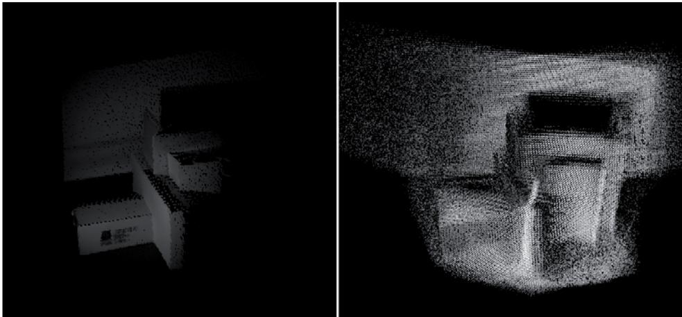
Abbildung 2: Links: Einzelnes Tiefenbild. Rechts: Aus mehreren Tiefenbildern akkumulierte Punktwolke.
