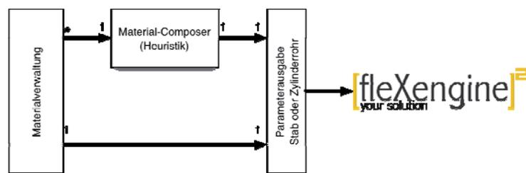
Abbildung 3: Der Material-Composer erhält von der Materialdatenbank alle Materialkenngrößen der Einzelkomponenten die zu einem Bündel komponiert wurden und errechnet anhand des mathematischen Modells die projektiven Kenngrößen eines Bündels.
