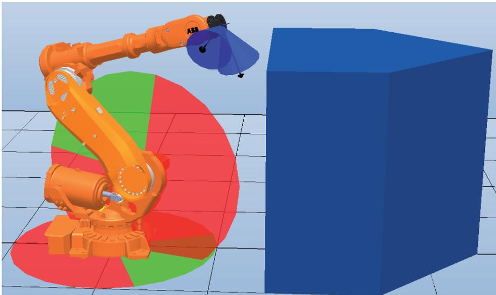
Abbildung 1: Visualisierung von zulässigen und verbotenen Achsbereichen (grün bzw. rot), einer Orientierungsüberwachung am Roboterflansch und dreidimensionalen Sicherheitszonen in RobotStudio.
