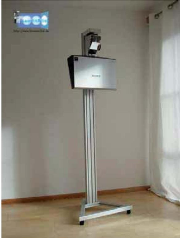
Abbildung 1: LumEnActive: Projektor und Reflexionseinheit montiert auf Profilschiene
