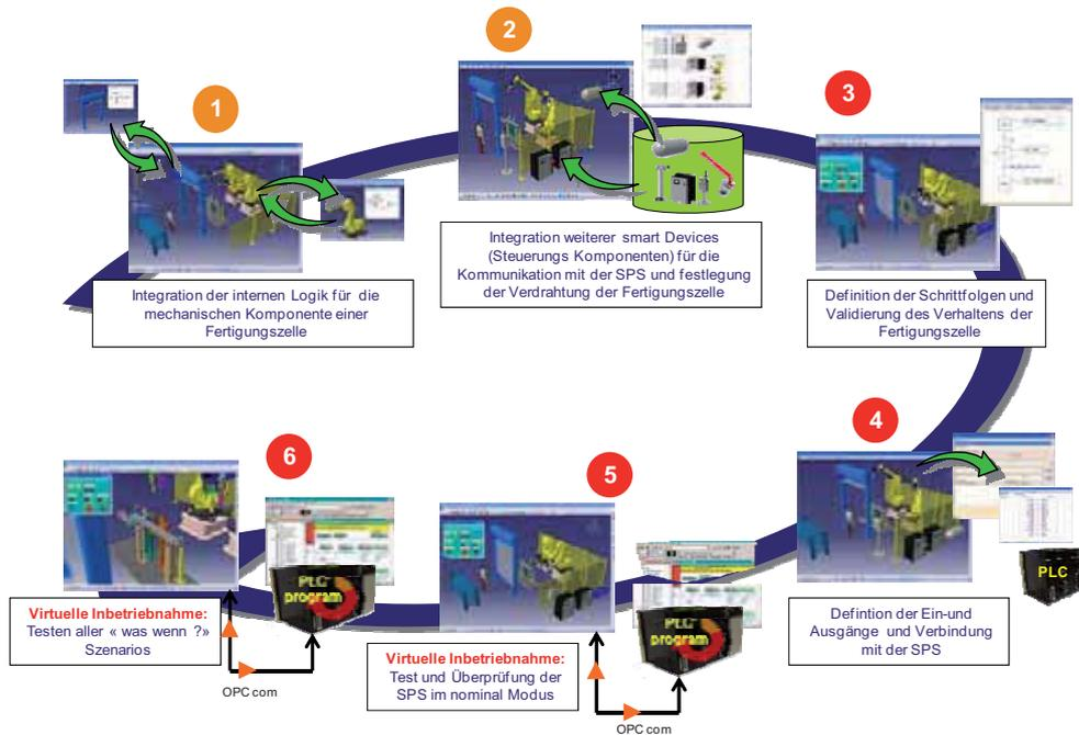
Abbildung 4: Workflow der virtuellen Inbetriebnahme.
