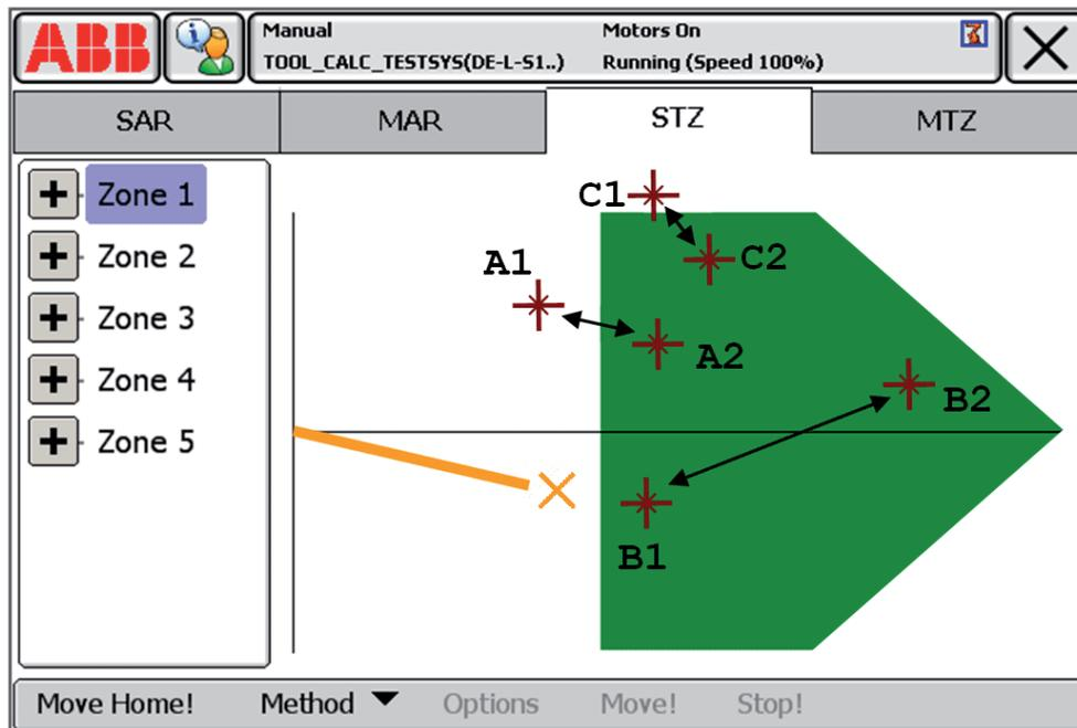
Abbildung 5: Testen von Zonengrenzen und Geschwindigkeitsvorgaben auf dem Bedienhandgerät. Der Roboter kann durch Antippen des Bildschirms an beliebige Positionen verfahren werden
