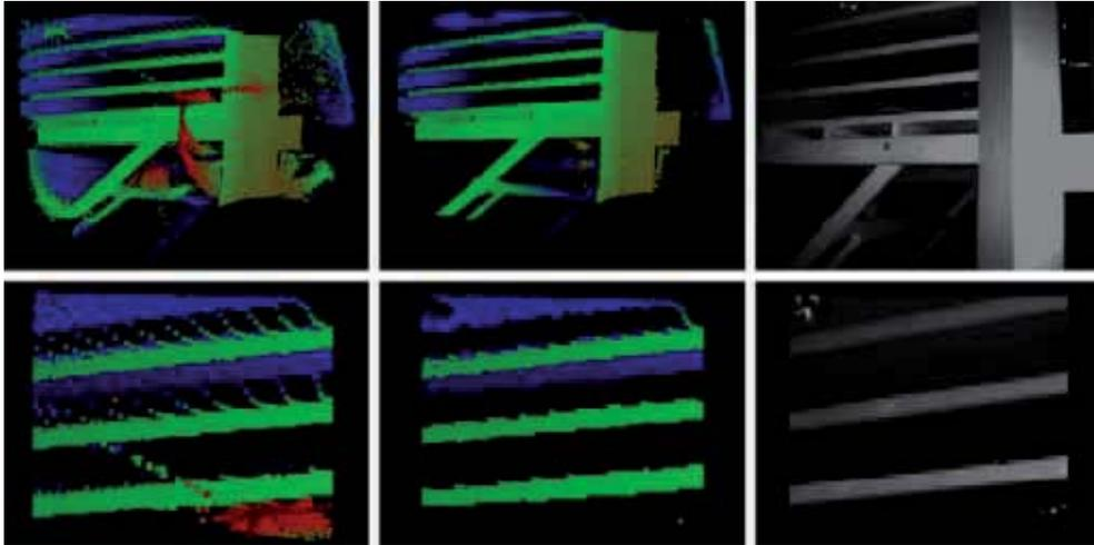
Abbildung 4: Links: Ungefiltertes Tiefenbild. Mitte: Gefiltertes Tiefenbild. Rechts: Intensitätsbild. In der unteren Reihe sind jeweils vergrößerte Bildausschnitte der obigen Bilder dargestellt.
