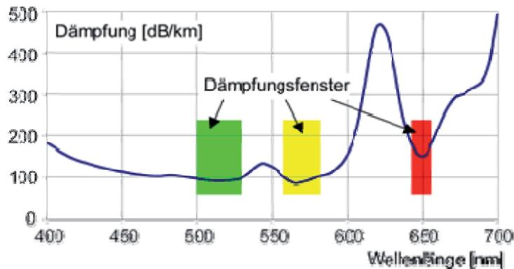
Abbildung 4: Dämpfung von POF bei unterschiedlichen Wellenlängen des Lichts; Quelle:[5]
