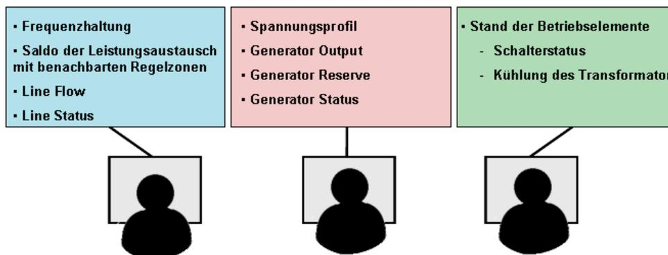
Abbildung 4: Aufteilung der Aufgaben bei der Überwachung des Netzes in der Leitwarte.
