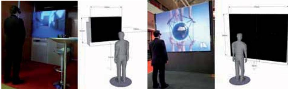
Abbildung 8: Konzept und Umsetzung eines einkanaligen (links) und eines mehrkanaligen (rechts) Stereo-Systems basierend auf eyevis 3D-Rückprojektions-Cubes
