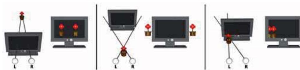
Abbildung 6: Probleme bei der Verwendung von Stereodisplays: Starker Konflikt zwischen Konvergenz und Akkomodation (links), zu nahe Darstellung eines Objektes (mitte) und Konflikt zwischen Konvergenz und Verdeckung (rechts)
