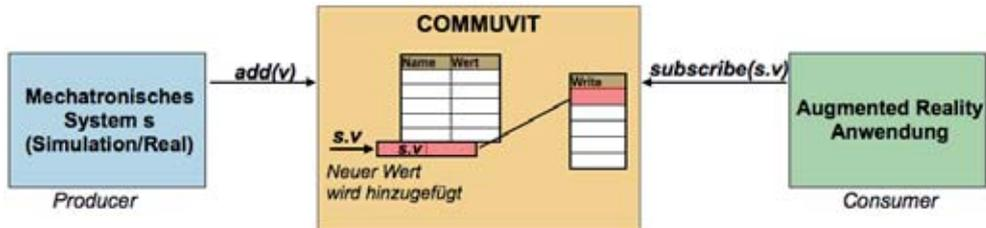
Bild 5: Prinzip des An- und Abmeldens einzelner Daten
