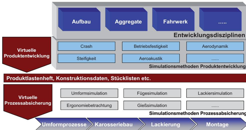
Abbildung 1: Virtuelle Produktentwicklung und Prozessabsicherung.
