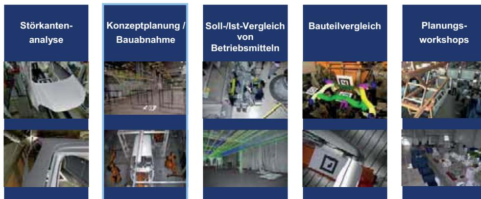
Abbildung 1: Anwendungsfelder von Augmented Reality im Bereich der Fertigungsplanung bei der Volkswagen AG.
