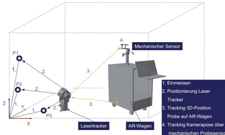
Abbildung 3: Funktionsweise des laserbasierten Large-Area-Trackings.
