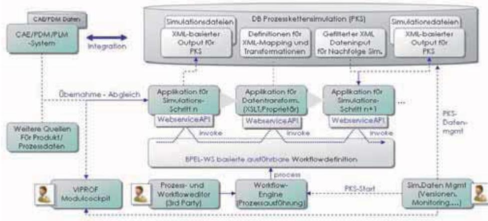
Abbildung 4: Software-Architektur zum Datenmanagement der Prozesskettensimulation („Datendrehzscheibe“).
