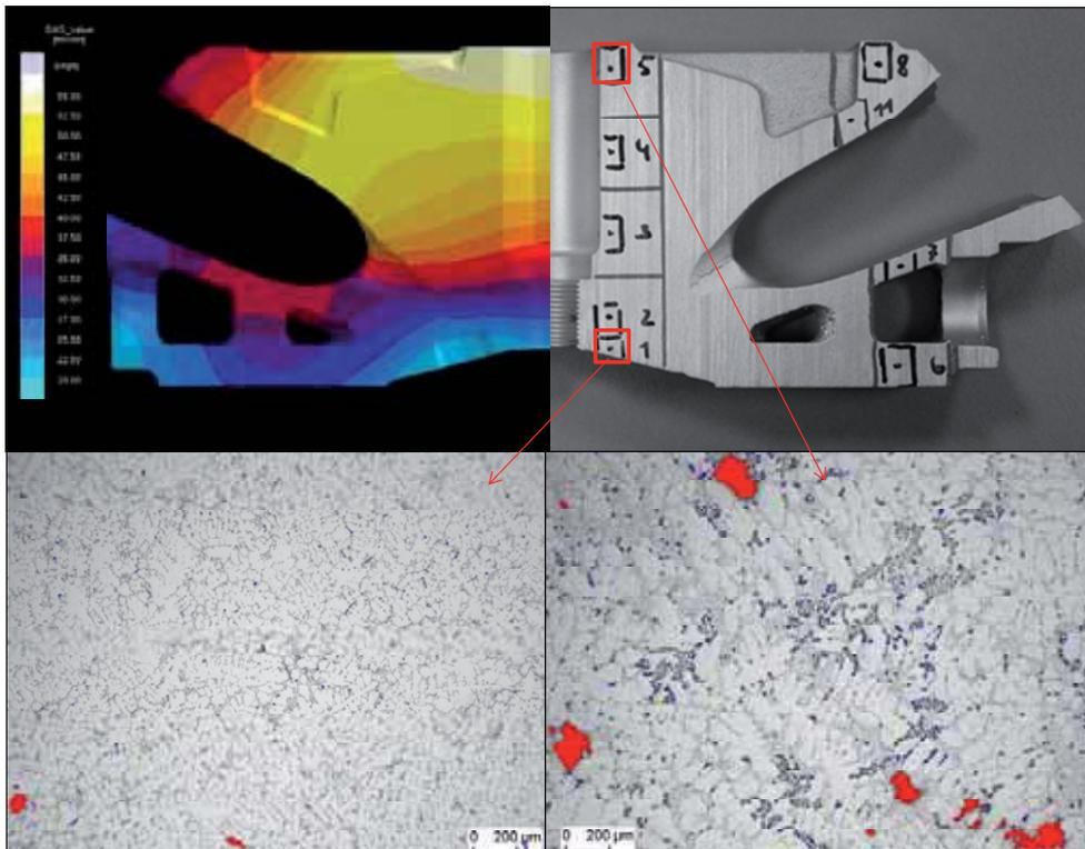
Abbildung 3: simulierte und reale Gefügemerkmale in einem Zylinderkopf (sDAS und Poren)
