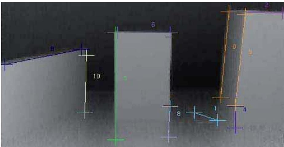
Abbildung 3: Tiefenbild (graukodierte Darstellung) mit detektierten 3-D-Kanten.
