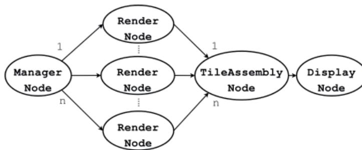
Abbildung 2 Beispiel für einen NMM-Flussgraphen innerhalb von URay
