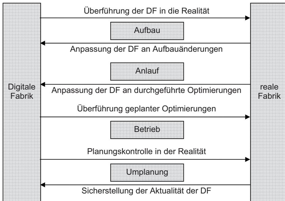
Abbildung 1: Zur Erhöhung der Potentialausschöpfung der Digitalen Fabrik notwendiger bidirektionaler Datenfluss zwischen der Digitalen und der realen Fabrik
