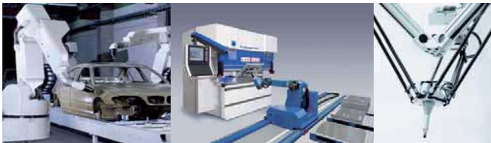
Abbildung 1: Anwendungsbeispiele mit KeMotion: Lackierroboter, Bedienung Abkantpresse, Pick&Place Parallelroboter
