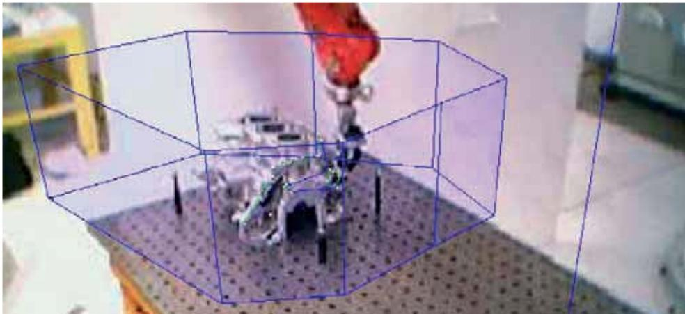
Abbildung 2: Augmented Reality zur Visualisierung einer Sicherheitszone, die das auf der Werkbank liegende Gussteil umschließt [2].
