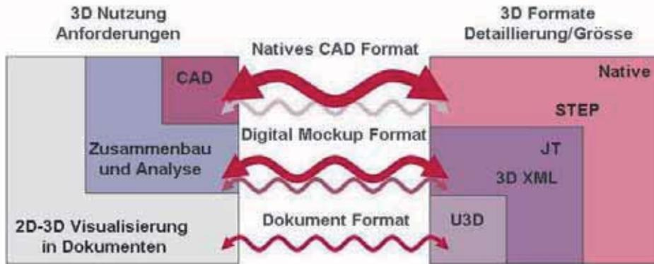
Abbildung 1: Spannungsfeld der 3D-Nutzung und der passenden 3D-Formate
