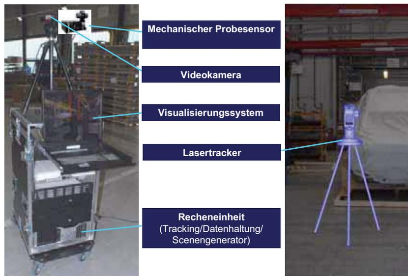
Abbildung 2: Systemsetup für die Augmented Reality gestützte Bau- und Layoutplanung mit Hilfe eines laserbasierten Large-Area-Trackings.
