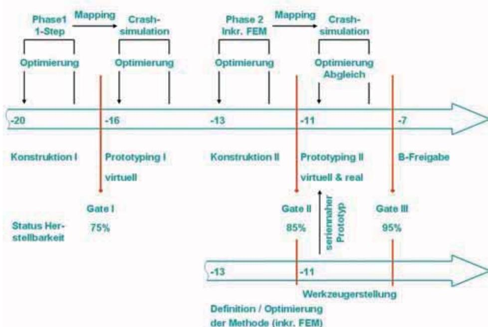
Abbildung 5: Konzept für die systematische Kopplung von Umform- und Crashsimulation in den verschiedenen Phasen der Produktentstehung.
