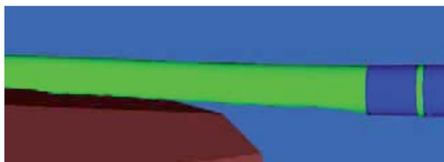
Abbildung 6: Reale Visualisierung des kumulierten Verschleißes am simulierten Schlauch
